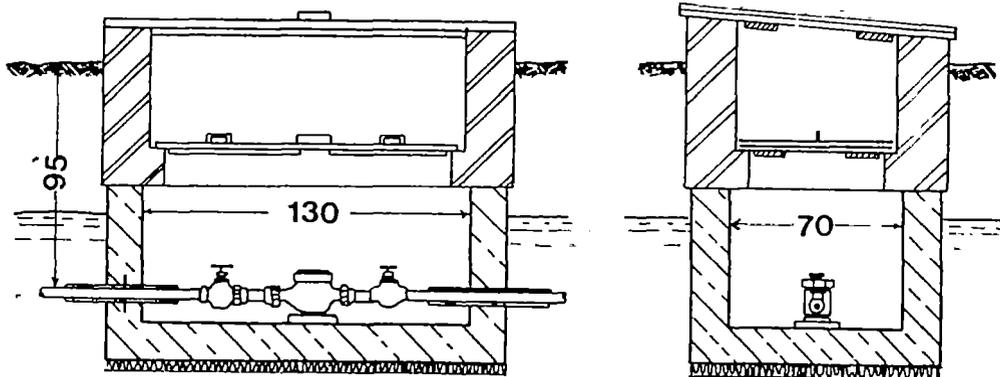
*Fig. 7. Water meter pit.*
