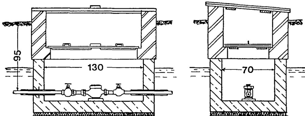
*Fig. 1. Typical meter box*
