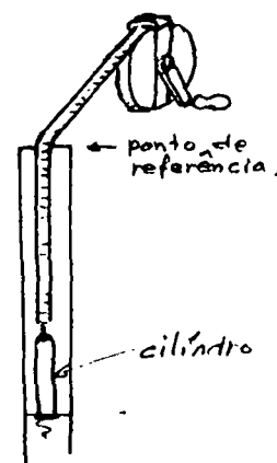
Figura 18: Medição do nível de água com um método acústico manual.
