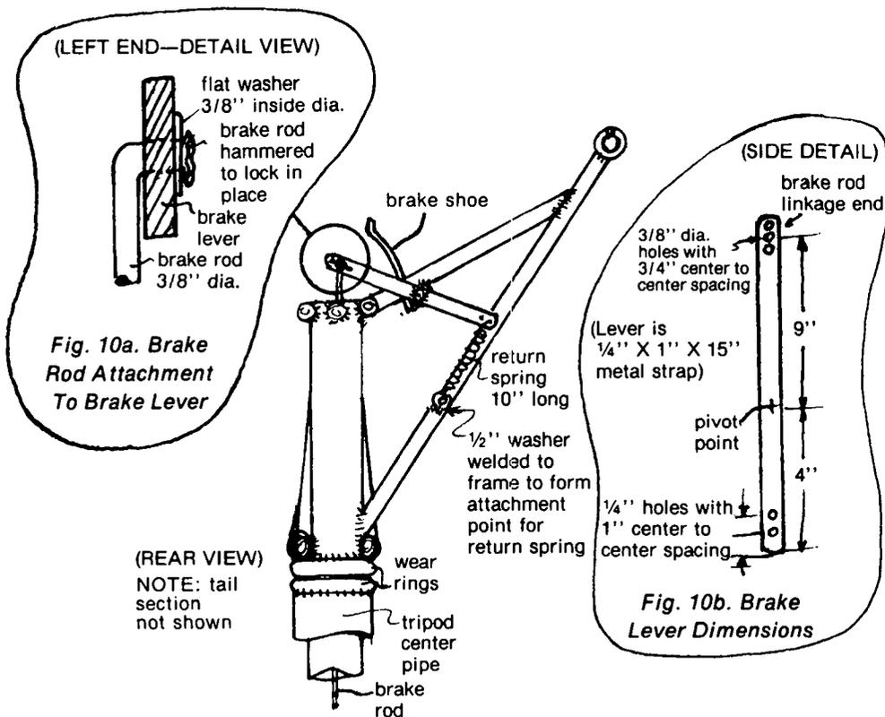
FIGURE 10. BRAKE LEVER ASSEMBLY IN POSITION
