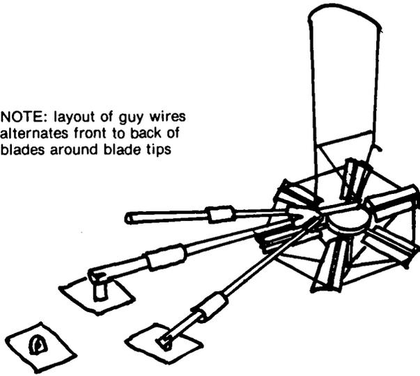
FIGURE 22. POSITION OF WINDMILL FOR HUB/BLADE ATTACHMENT TO TAIL & SUPERSTRUCTURE
