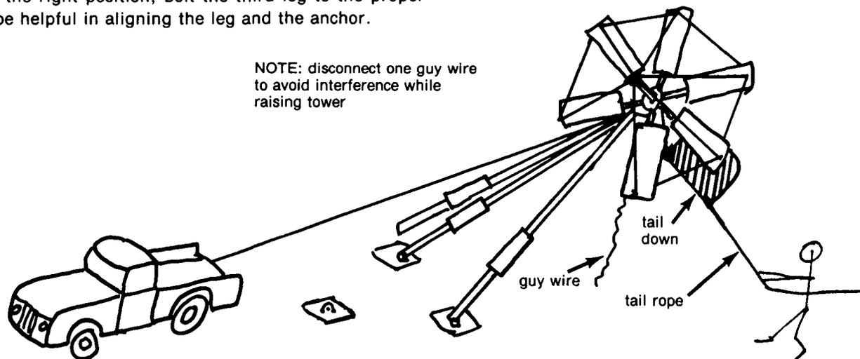
FIGURE 23. POSITION OF WINDMILL JUST BEFORE BEING PULLED INTO PLACE
