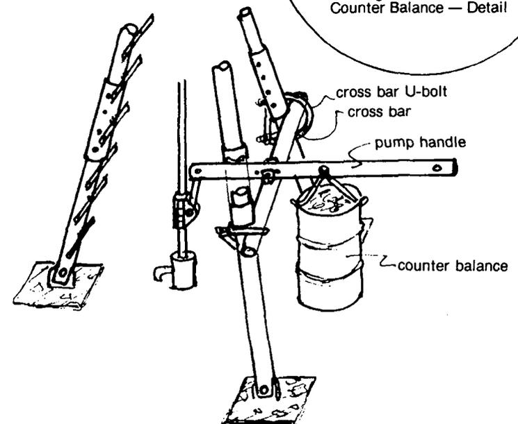
FIGURE 7. PUMP HANDLE & COUNTER BALANCE
