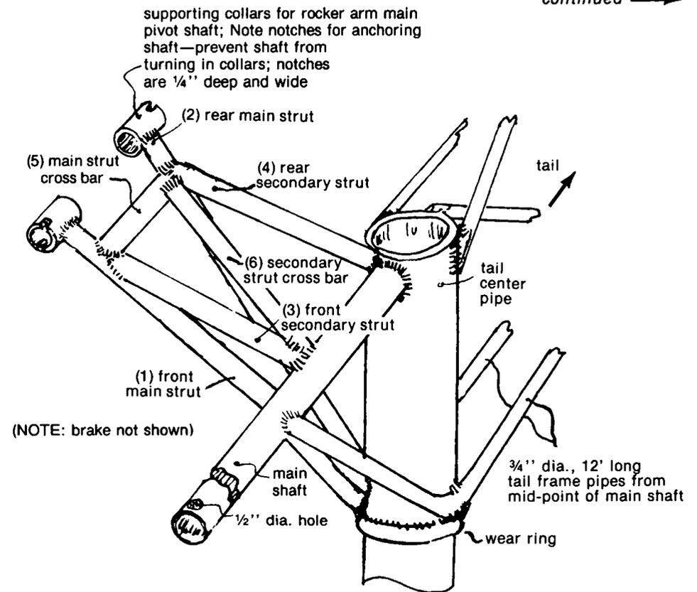
FIGURE 9. ROCKER ARM SUPPORT HOUSING
