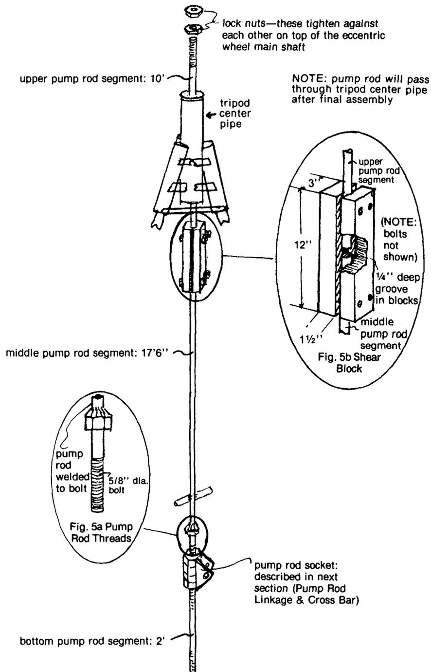
FIGURE 5. PUMP ROD & SHEAR BLOCK
