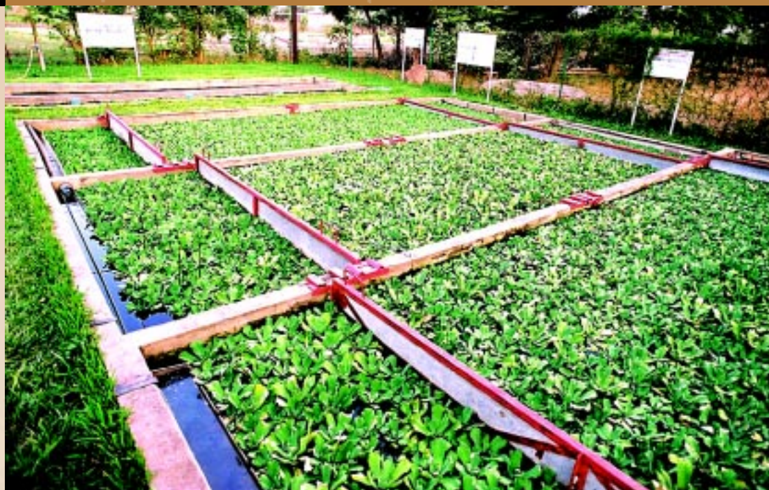
Recherche expérimentale en matière d'utilisation des plantes aquatiques pour le traitement de l'eau, Ecole d'ingénierie en équipement rural (EIER) à Ouagadougou.
