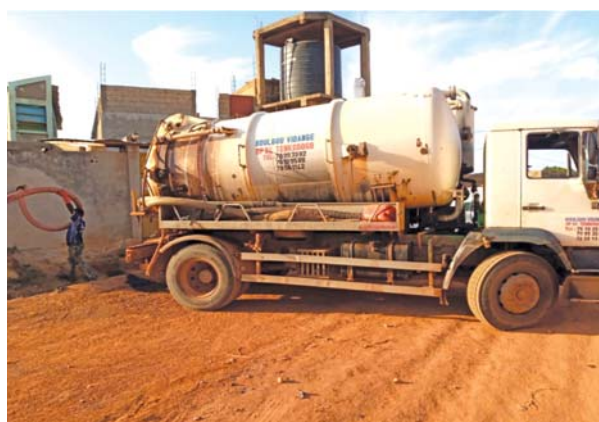
Vidange des fosses d'un ménage par l'entreprise Boulga Service, Tenkodogo le 13/11/2021
